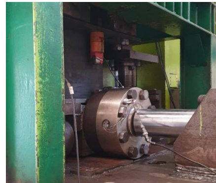
Gambar 6 Mesin seismik pada alat pengujian Factory Production Control (FPC) Test
