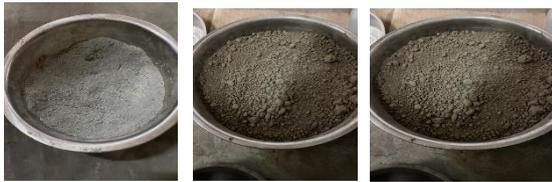
**Gambar 1 Material Penyusun Paving Blok (Semen, Pasir dan FABA)**
