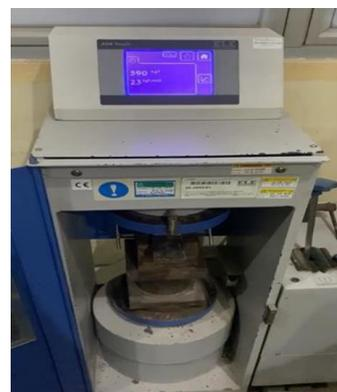
Gambar 8 Alat Uji Kuat Tekan *Paving*
