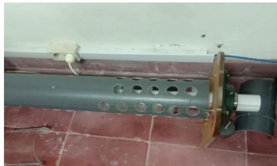
**Gambar 3 Pipa PVC Diameter 5 Inci dengan Lubang-Lubang yang Akan Ditempel Filter**
