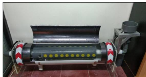
**Gambar 4 Pipa PVC Diameter 8 Inci Sebagai Penahan Air yang Tersaring**
