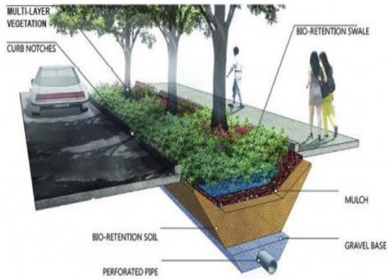
Gambar 3 Skema Bioswale di Jalur Hijau Jalan (JHJ) di Kawasan Perkotaan
