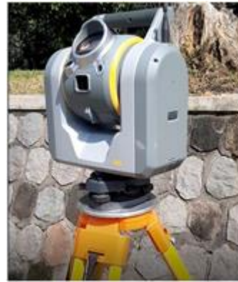
Gambar 4 Proses Pemindaian Kolom Eksisting menggunakan Laser Scanner
