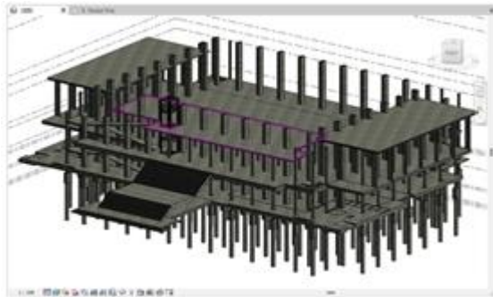
Gambar 6 Pemodelan Kolom berdasarkan Data Laser Scanner
