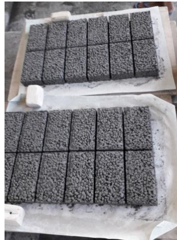
Gambar 4. Proses pencetakan paving block (kiri) dan Hasil akhir paving block berbahan beton non pasir (kanan)
