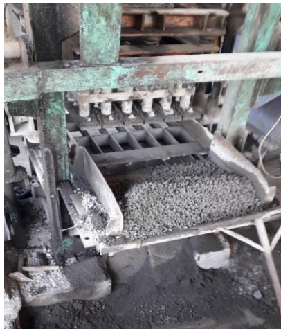
Gambar 4. Proses pencetakan paving block (kiri) dan Hasil akhir paving block berbahan beton non pasir (kanan)
