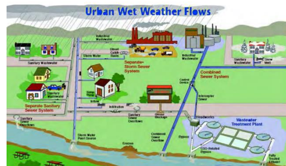
Gambar 1 Konsep pemodelan jaringan drainase dengan SWMM
